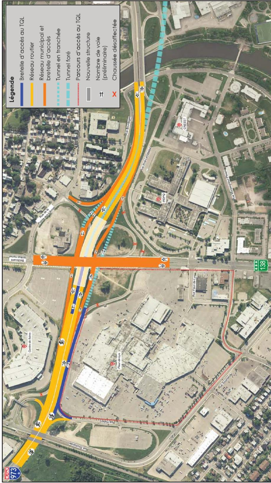
Cette option comprend la fermeture de l'accès à l'A-973N à partir de la Pointe-aux-Lièvres. La sortie à partir de l'A-973N vers Hamel Est doit être déplacée sur la bretelle existante vers Pointe-aux-Lièvres. L'ajout d'une nouvelle bretelle d'accès à Hamel à partir du Tunnel et un accès au tunnel à partir d'Hamel via les rues Monseigneur-Plessis, Sourmande, puis Hubert.
